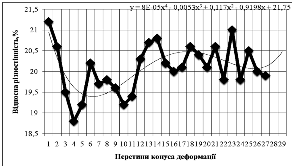
Рис. 3. Зміна відносної поперечної різностінності труб у 27 перерізах робочого конуса при прокатці з подачею та поворотом у крайніх положеннях кліті (стан ХПТР 15-30, 28 \times 3,2 – 25,4 \times 2,65 мм)
